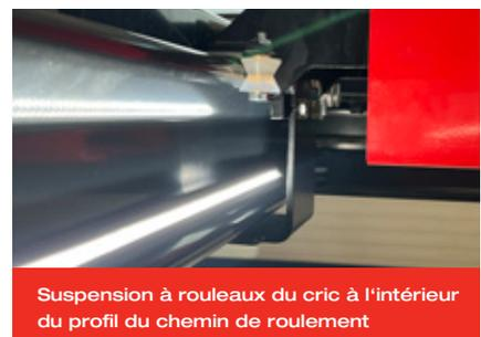
Suspension à rouleaux du cric à l'intérieur du profil du chemin de roulement
