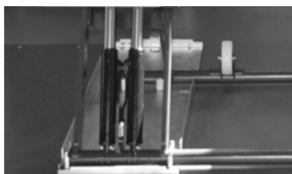
Système à doubles-vérins, pas d'air comprimé nécessaire
